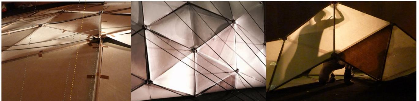
*Résultat des premiers essais de fabrication en fibre de lin/résine : performance technique, opacité, transparence*
